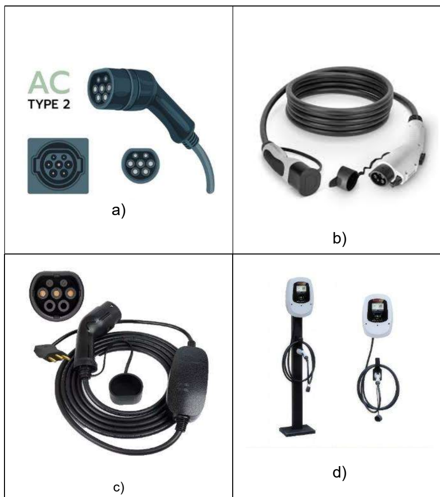
Figura 30 - Imagens Ilustrativas: a) Plugue e tomada tipo 2 (padrão europeu); b) Cabo de recarga, c) Carregador portátil (tipo 2) para uso doméstico/emergencial em tomada de 20A; d) Carregadores com cabo de recarga fixo, montados em parede e/ou poste.
