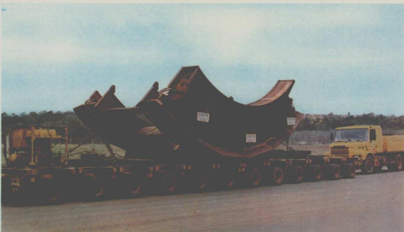
**ACIMA:** O rotor da turbina da unidade geradora nº 6, no momento da descarga, no edifício de descarga central, da central hidrelétrica de Itaipú.
